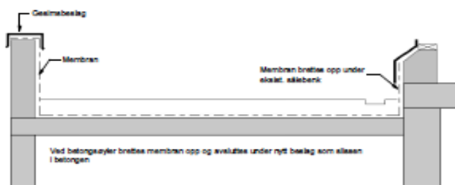
Detali oppkant Teknisk rom/kulvert 1:20
